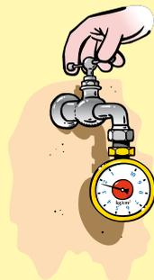
Exprimée en kilogrammes par centimètre carré ( $kg/cm^2$ ) ou en bar, elle se mesure à l'aide d'un manomètre branché sur votre robinet d'arrivée d'eau. Si vous n'avez pas de manomètre demandez la pression à la société des eaux\*.
